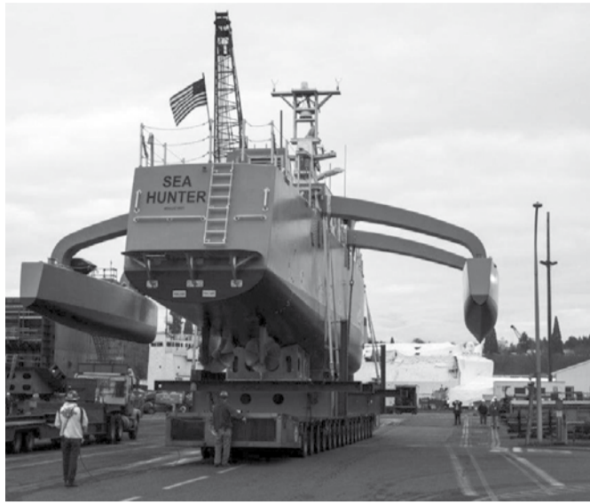
La prima nave da guerra drone, a pilotaggio remoto, si chiama "Sea Hunter". E' stata consegnata alla US Navy dopo due anni di test in mare e fa parte del programma del DARPA (Defense Advanced Research Projects Agency) per la lotta antisommersibile. Il prototipo è lungo 40 metri, può viaggiare a una velocità di 27 nodi e trascorrere fino a sei mesi in mare senza equipaggio a bordo. Il costo giornaliero per far funzionare l'unità è di circa 20 mila dollari al giorno, molto più basso dei 700 mila per un cacciatorpediniere con equipaggio. Chissà che un giorno questa nuova classe di navi non potrà essere utilizzata nella lotta anti pirateria
